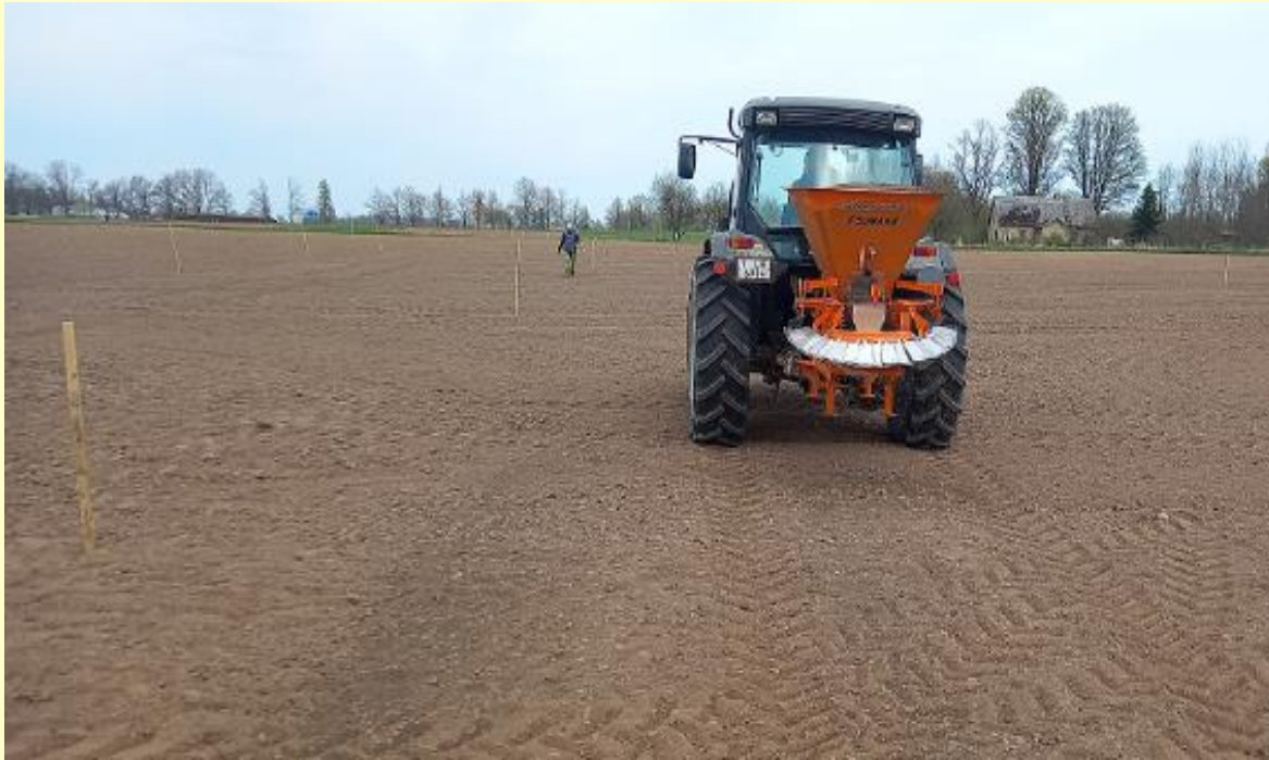
Koksnes pelnu izkliede ar kaisītāju Sand 400, SaMASZ, kas paredzēts smilts izklidei, Stende (24.04.2023.)
